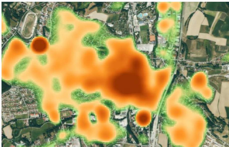
Abbildung 3: Exemplarischer Ausschnitt zur Darstellung der Wärmedichte auf Grundlage des gebäudescharfen Wärmekatasters [Bayerische Vermessungsverwaltung, eigene Bearbeitung]
